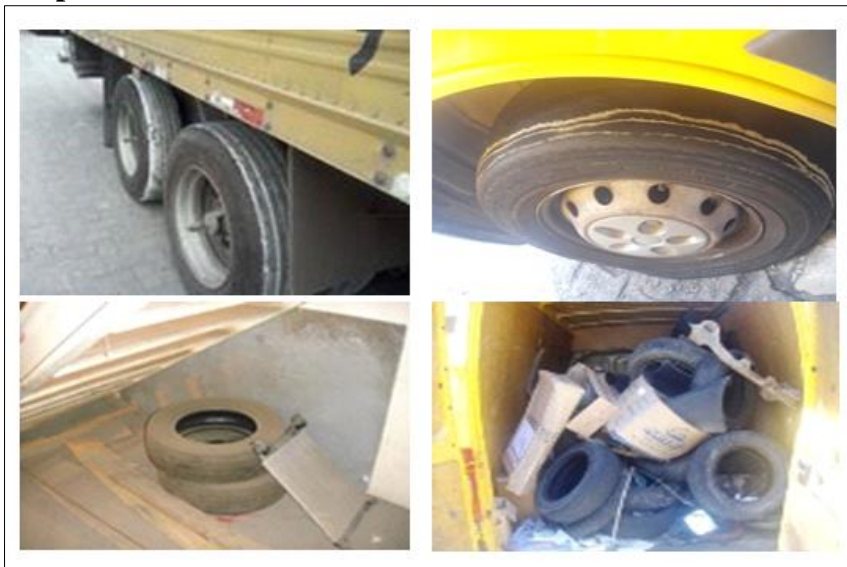
Figura 3 – Painel de veículos operacionais (em uso) com pneumáticos com desconformidades – Salvador – Bahia
