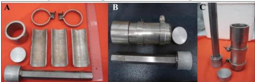
Figura 6 – Componentes do molde tripartido
